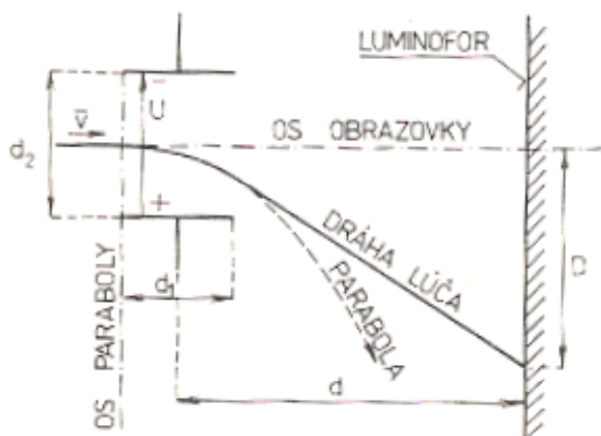
obrázok 11. Výchylka lúča pri vychýľovaní elektrostatickým poľom.
